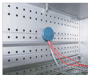
Foro di accesso con tappo in silicone
