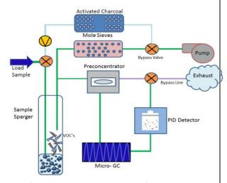
La colonna del GC è più piccola di una moneta da 1 euro e, grazie all'utilizzo di nano composti, è possibile alloggiare in uno spazio ridotto, una colonna da 4,8 metri. La colonna è dotata di un sistema di termostatazione che permette di lavorare sia in isoterma che in rampa di temperatura, potendo raggiungere i 180°C.
