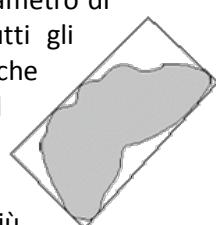
Infine possiamo avere il "minimum area bounding rectangle" che corrisponde al più piccolo rettangolo che è possibile costruire attorno alla particella. Questo valore viene calcolato come il prodotto minimo di ogni possibile coppia di (xFeret, xFeret, 90)
