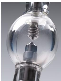
La speciale lampada allo Xenon utilizzata per l'analisi è costituita da una sorgente continua che rende disponibili tutte le lunghezze d'onda da 185 a 900nm a fini analitici. Questo permette non solo di avere numerose lunghezze d'onda per l'analisi dei metalli, ma anche la possibilità di sfruttare bande molecolari per la determinazione dei non metalli.
